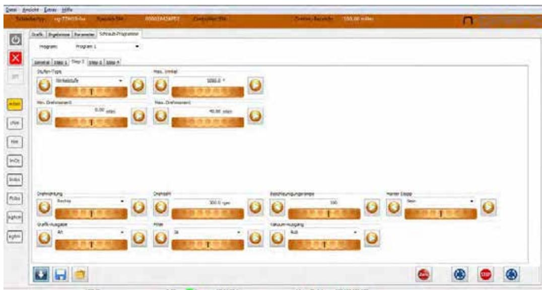
Die Winkelstufe dient dem schnellen, drehwinkelgesteuerten Eindrehen der Schraube zur Prozesszeitoptimierung. Der Parameter Drehwinkel ist dabei so einzustellen, dass die Kopfauflage der Schraube noch nicht erreicht wird.
