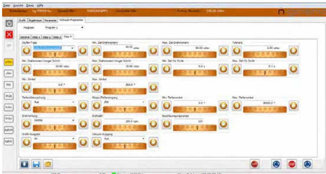
Die Delta-Drehmomentstufe ermöglicht es, nach Erkennen der Kopfauflage einen fixen oder variablen Betrag zusätzlichen Drehmoments in die Schraubverbindung einfließen zu lassen. Das Ziel ist hier, eine möglichst konstante Klemmkraft zu erreichen, auch wenn die Werkstücke Abweichungen des Drehmoments bis zur Kopfauflage aufweisen.
