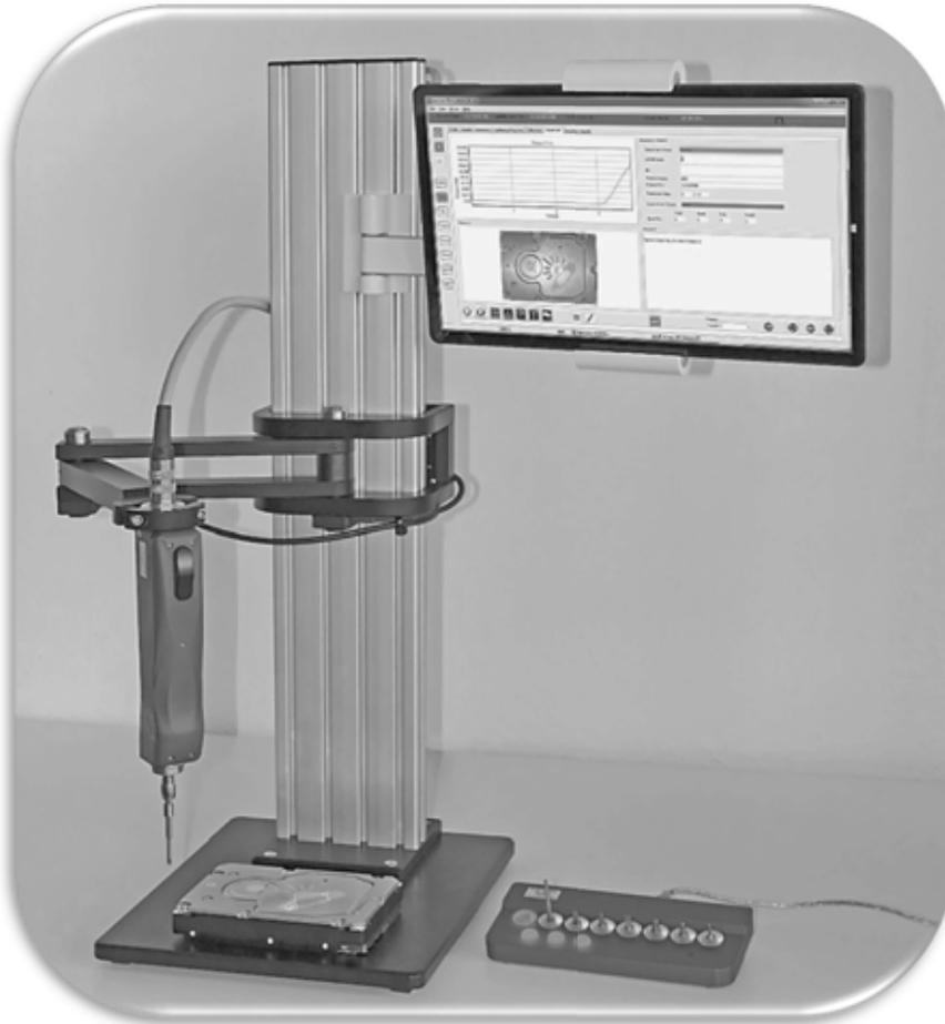
Gerätehalter mit vertikaler Linearführung und zwei Gelenkachsen
