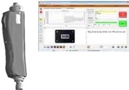
2. **ng-TDH** Sensor-Schraubsystem und **n-quirer TD advanced** im Sequenzer-Modus, mit Barcodeleser zur Programmaktivierung und Zuordnung der Werkstück-Identität (bis zu 10 Teile einer Baugruppe können nacheinander gescannt werden)
