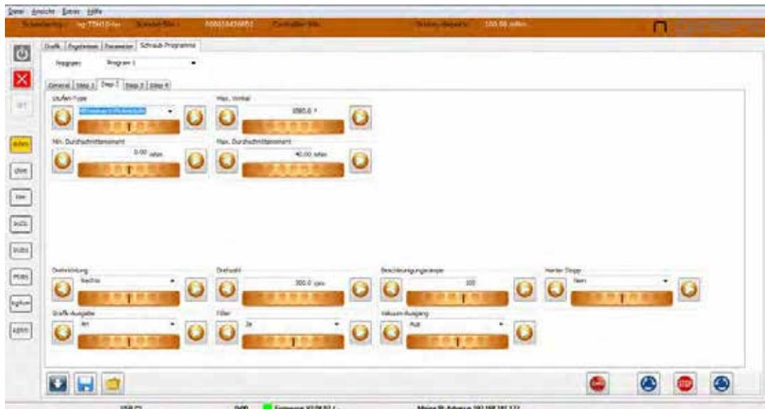
Die Mittelwert-Winkelstufe dient der Messung des (arithmetischen) Drehmoment-Mittelwerts während der Messung über einen programmierten Drehwinkel. Grenzkriterien sind hierbei der maximale und der minimale Durchschnittswert.
