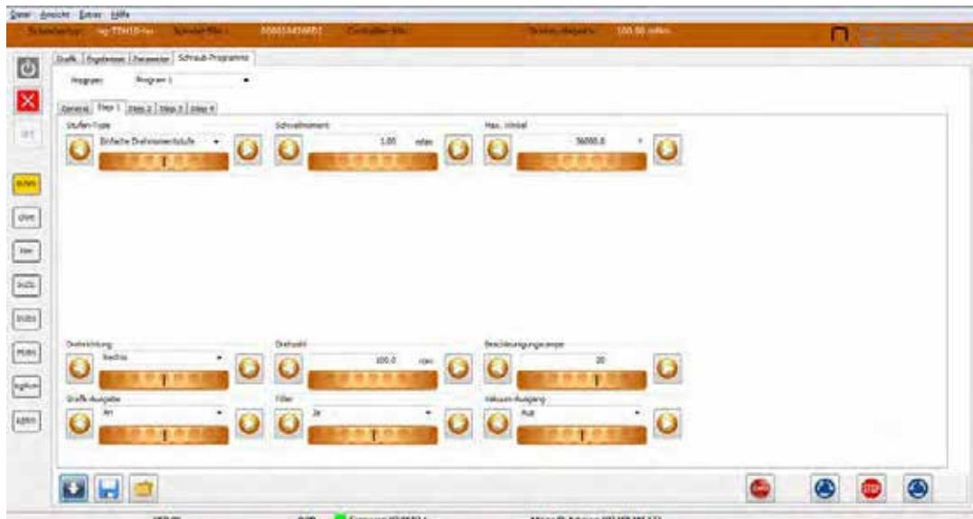
Die einfache Drehmomentanzugstufe erleichtert den Eingriff der Schraubklinge in den Mitnehmer der Schraube und hilft schräges Ansetzen der Schrauben zu vermeiden.
